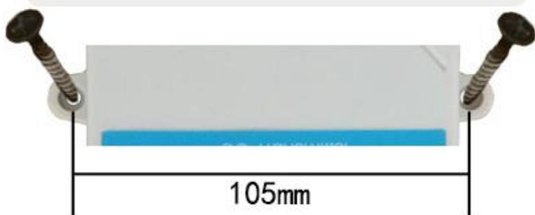
壁挂王字壳为壁挂式安装，安装孔位于设备两侧中部位置，安装孔径小于 4mm，孔距 105mm，可使用 3mm 的自攻螺丝安装。
